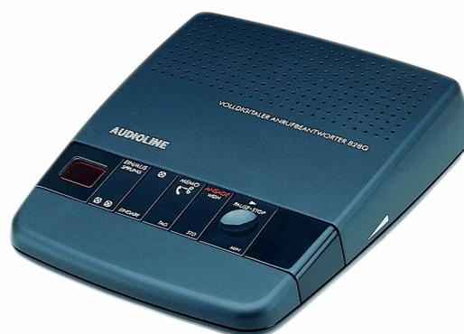
Alte Anrufbeantworter haben für Anrufe und Ansagetexte getrennte Kassetten. Es gibt auch Mischformen, bei denen der Ansagetext digital, der Anruf dagegen auf einer Kassette gespeichert wird. So hat man mehr Kapazität für die Texte der Anrufer zur Verfügung.
